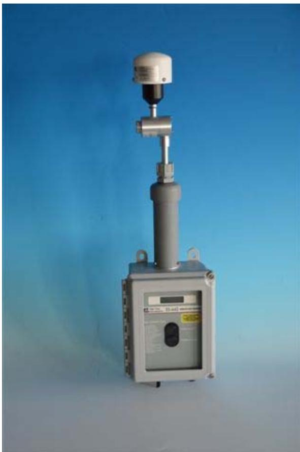
\* 環境を選ばず粒子濃度を連続して測定できる構造をしています。
